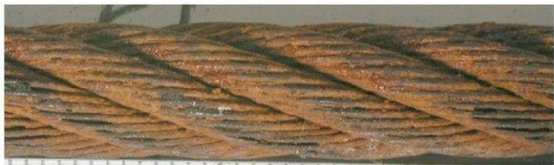
شکل ح- ۴ - سطح طناب به شدت خوردگی حفره ای دارد و طناب ها کاملا شل شده اند و فواصل بین سیم ها بلافاصله از رده باید خارج شود -
