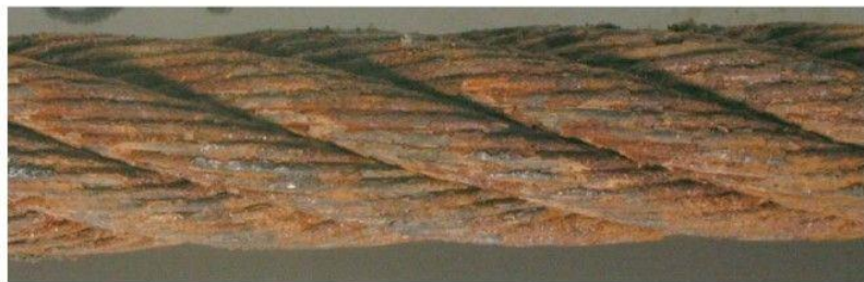
شکل ح- ۳ - سطح طناب به شدت زنگ زده است - نرخ شدت ٪ ۶۰ متمایل به از رده خارج سازی
