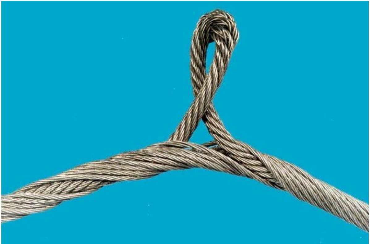
شکل ب ۱۵ - برآمدگی طناب های درونی در طناب های نتاب
