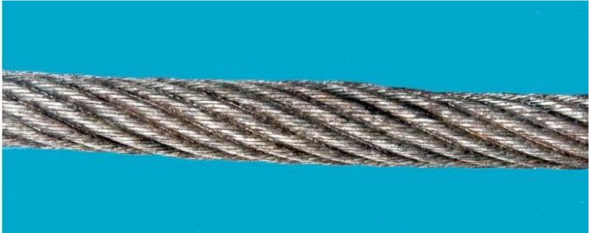
شکل ب ۱۶ - افزایش قطر موضعی در طناب در اثر اعوجاج هسته
