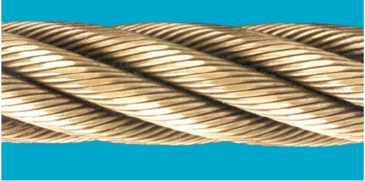
شکل ب - ۱۰ - فرسایش خارجی
